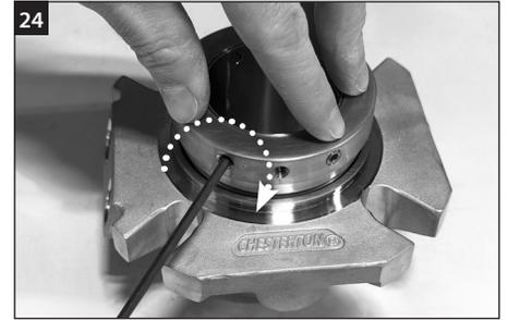
握住整个密封组件，小心地将其翻转、旋转并放在干净的工作面上。用力按住定位环顶部，将 1/4 夹头定位螺栓拧入轴套的小孔中。均匀拧紧 1/4 夹头螺栓，以保持定位环与轴套正确对中。小心：切勿因过度拧紧 1/4 夹头定位螺栓而导致轴套偏移。1/4 夹头定位螺栓不得从轴套内径伸出。
