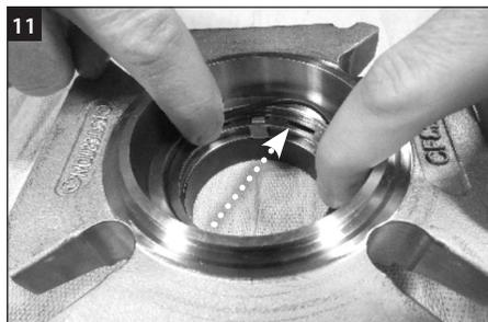
小心翻轉壓蓋並將其放在乾淨的布上，以保護內側密封環表面。在剩餘的靜 O 型環 (X) 上塗抹一層潤滑脂薄膜，並安裝到壓蓋的內徑凹槽中。
