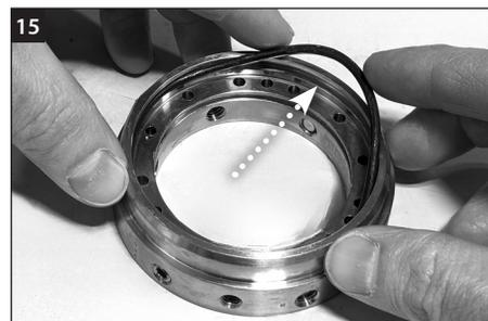
在定位環支架 O 型環 (U) 上塗抹一層的潤滑脂薄膜，然後將其插入內徑較大的定位環凹槽中。
