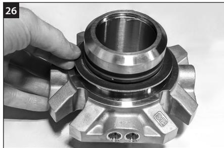
将密封腔垫片安装到压盖凹进处中。
