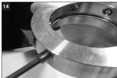
**重要事項：**安裝到密封軸套上之前，定位螺栓不應突出到定位環內徑中。
