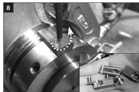
卸下所有平頭螺釘和定心夾，保留以備將來調整葉輪和/或拆卸密封件時使用。
