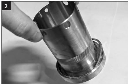
在回轉 O 型環 (W) 上塗抹一層潤滑脂薄膜並將其安裝到軸套組件內徑的凹槽中。
