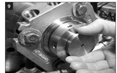
重要事項：為確保壓蓋在軸套上正確對中，用手轉動軸並確保密封件轉動自如。如果聽到或感覺到密封件內有金屬間的接觸，則說明密封件未正確對中。重新安裝定心夾，用手指擰緊。拆除所有管路連接。擰松壓蓋螺栓。完全擰緊定心夾。擰松定位螺栓。重新擰緊壓蓋螺栓。重新擰緊定位螺栓。取下定心夾。如果在金屬之間仍存在接觸，請檢查密封腔是否對中。
