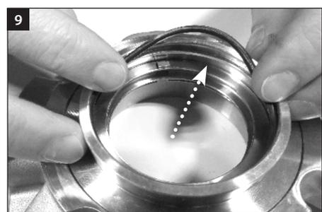
在靜 O 型環 (X) 上塗抹一層潤滑脂薄膜，並安裝在適配器的內徑凹槽中。
