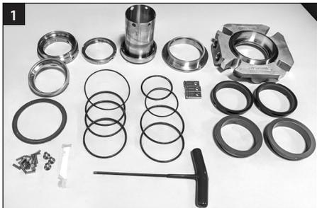
組裝密封件所需工具：六角扳手和潤滑脂（隨密封件提供）；無絨布、鑷子或細拾取器（用戶自備；用於安裝 O 型環）。使用經批准的溶劑清洗所有金屬部件，包括所有墊片和 O 型環表面。將金屬部件和所有備用密封部件放在乾淨乾燥的表面上。
