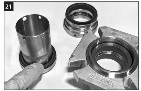
最终组装部件之前，用干净的布和经批准的溶剂清洁所有密封环表面。
