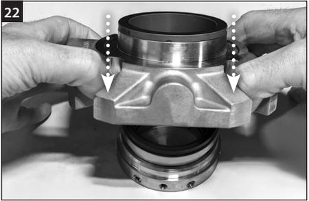
将压盖放在定位环元件上，Chesterton 标记朝下，将静密封环端面与回转密封环端面对齐。
