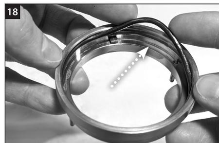
在外側回轉 O 型環 (W) 上塗抹一層潤滑脂薄膜，並將其插入內徑較大的支架組件凹槽中。
